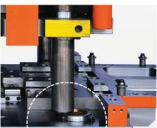
Nessuna sicurezza per lo stampo e per i lavoratori. Nessuna stabilità. Pericolo di ammaccamento.
