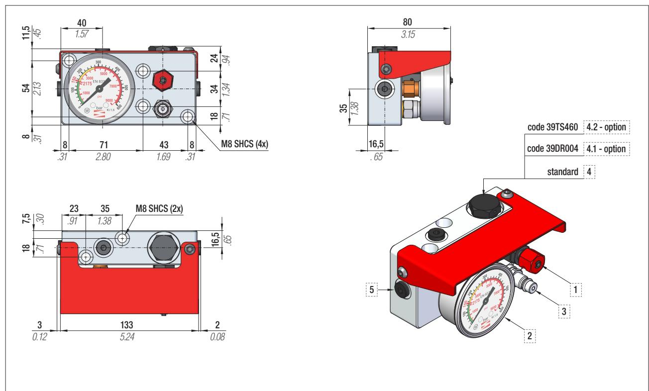
Pannello standard per caricamento, regolazione, scaricamento e controllo della pressione nel sistema collegato. Consiste in una base provvista di manometro, valvola di caricamento e scaricamento, 3 uscite, protezione in acciaio. Può essere equipaggiato con disco di rottura (opzionale).
