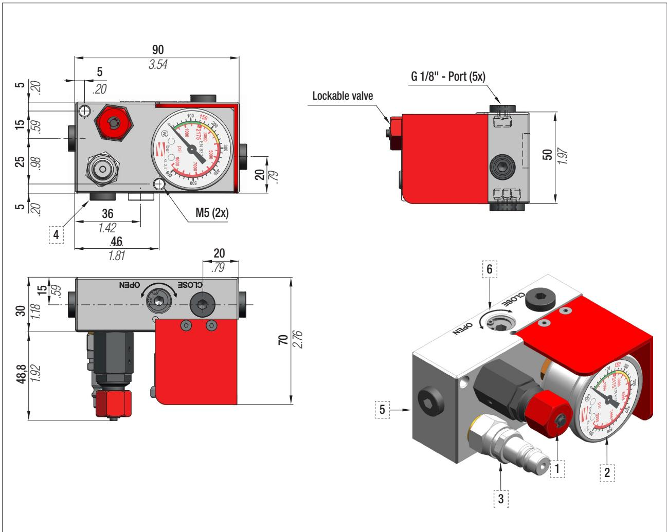
Il mini pannello di controllo Special Springs, grazie a un design miniaturizzato e unico, offre una grande flessibilità d'uso che aumenta con le unità addizionali AUMCP. Consiste in un blocchetto di alluminio provvisto di manometro, valvola di caricamento e scaricamento, 4 uscite, valvola d'intercettazione e tappo di rottura sovrappressione.
